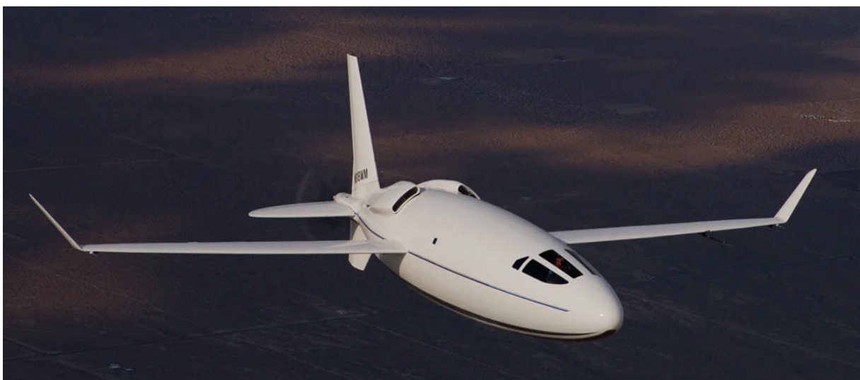
Otto Celera 500 L. Stromlinienförmiger Rumpf, Laminarströmung, Flügel mit hoher Streckung, RED A03 Dieselmotor, MT-Propeller (Otto Aviation).
