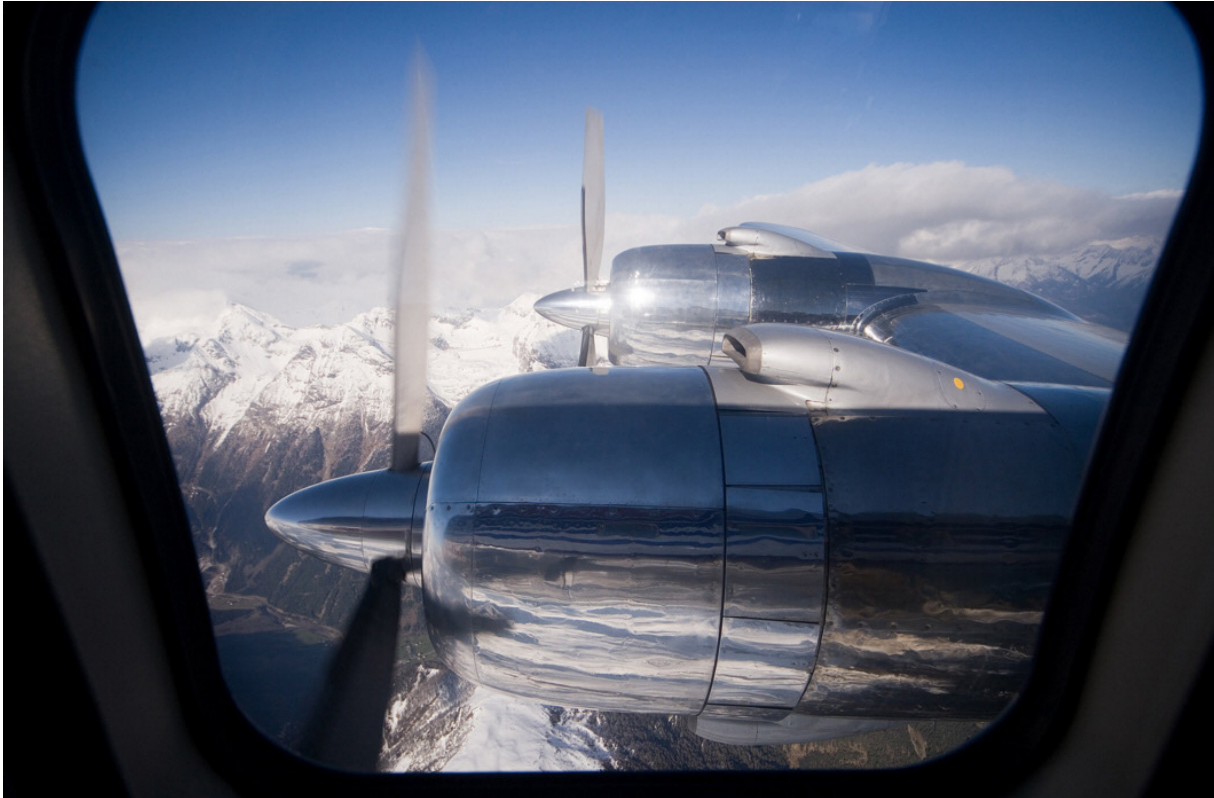
Triebwerke Pratt & Whitney R-2800 (2400 PS) mit Propellern Hamilton Standard 43E60 "Hydromatic" als Constant-Speed Propeller an der DC-6 (The Flying Bulls).
