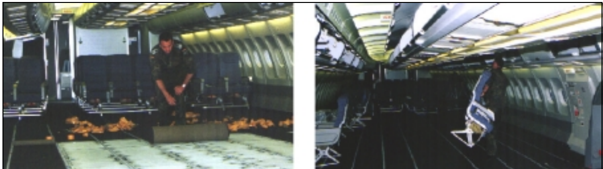
Bild 5.19 Einfacher Umbau vom Frachtflugzeug zum Passagierflugzeug (WTD 2003)
