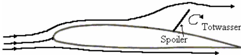
**Bild 3.2** Strömungsveränderung durch einen Spoiler
