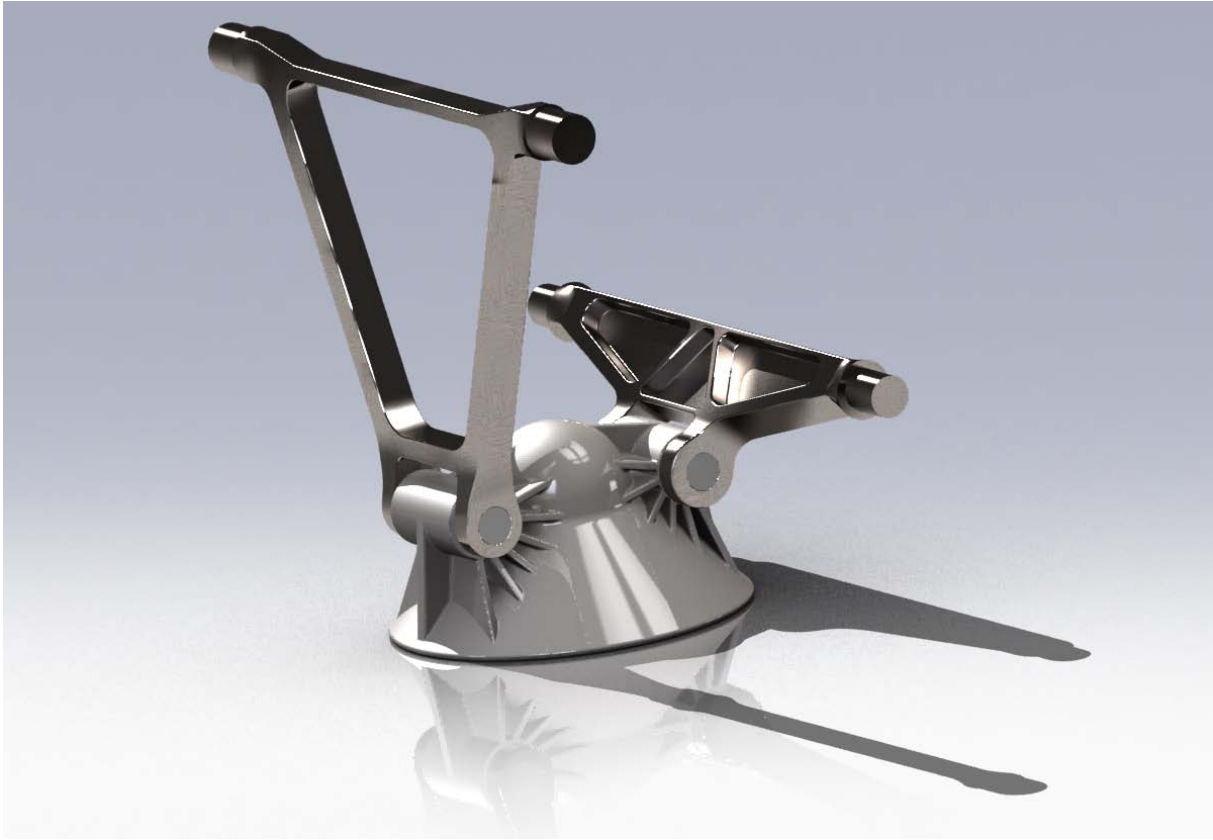
Bild 6.11 Komplette Baugruppe Schnittstelle Rumpffahrwerk
