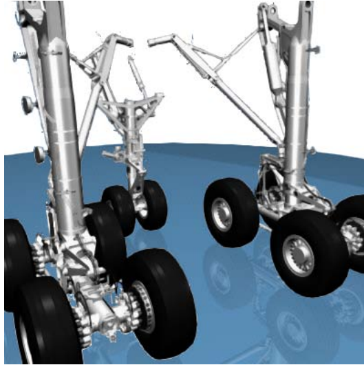
Bild 4.1 Fahrwerkskonfiguration beim A330 (nach Turbosquid 2007 )
