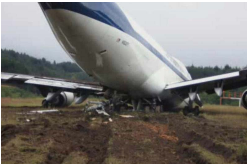
Bild 3.2 Abbruch des Fahrwerks bei Landebahnüberschreitung ( Binnebesel 2010 )
