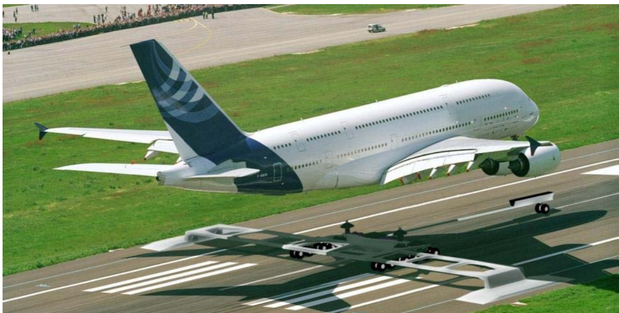
Bild 1.2 Flugzeug mit einem bodengebundenen Fahrwerkssystem ( Dilba 2009 )
