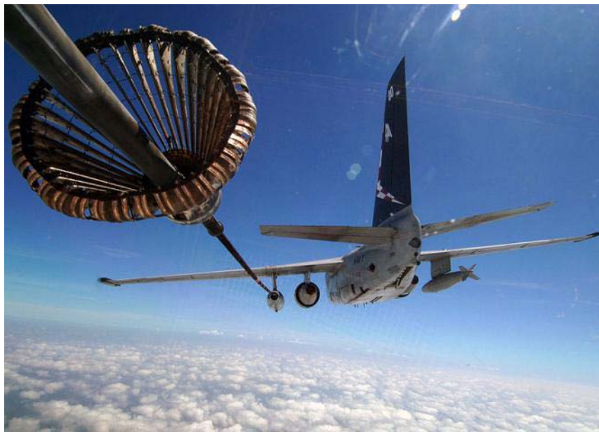
Bild 5.9 Fangtrichter zur Luftbetankung ( Defense 2010 )
