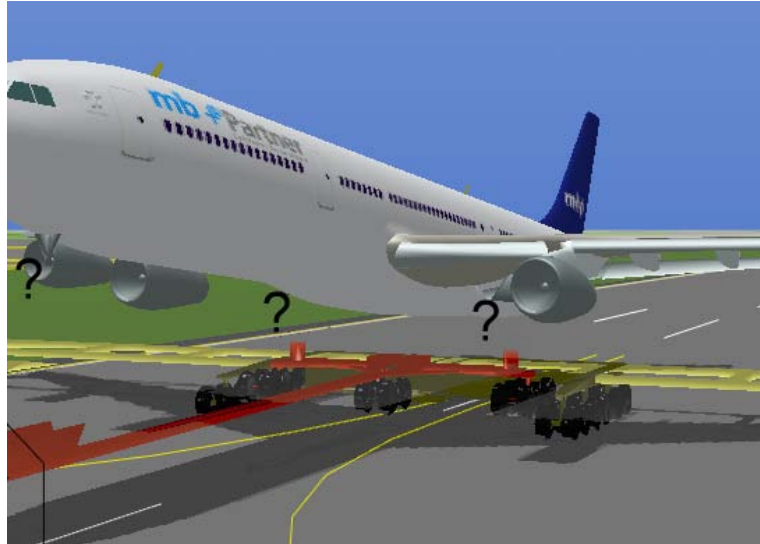
Bild 5.1 Schnittstelle zwischen Flugzeug und Bodenfahrwerk (nach Binnebesel 2010 )
