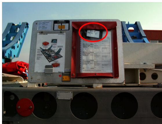
Bild 5.19 Befestigungsort der Transponder
