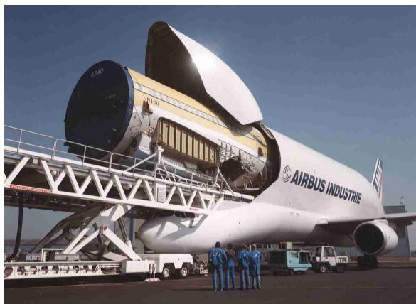
Bild 5.18 Beladevorgang am Beluga
