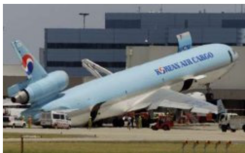
Bild 3.4 Auswirkung falscher Beladung
