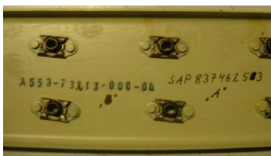
Bild 4.1 Beispiel einer ungenügenden Teileidentifikation
