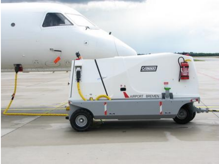
Bild 3.4 Bodenstromgerät im Einsatz (Weyer 2012)
