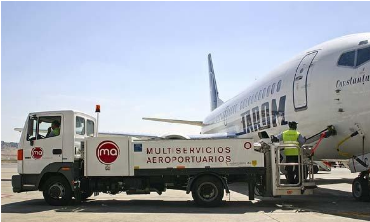
Bild 3.18 Fäkalienservicewagen mit Arbeitsbühne (Vestergaard 2012)
