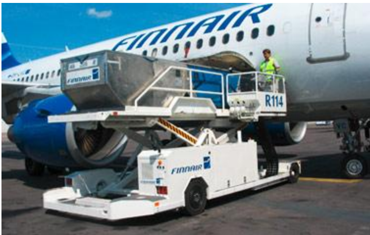
Bild 3.9 Hubtransporter an der Ladeluke eines Airbus A320 (Laweco 2012)
