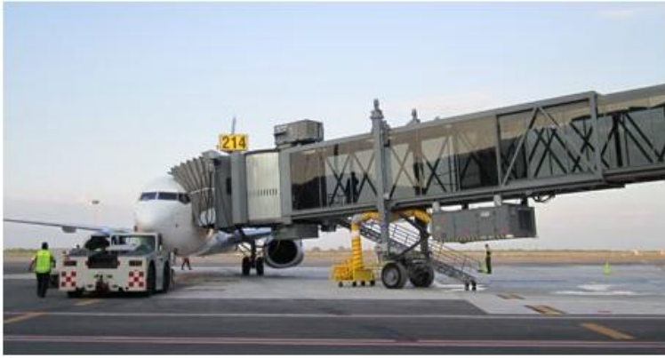
Bild 3.6 Fluggastbrücke an der vorderen Tür (JBT 2012)
