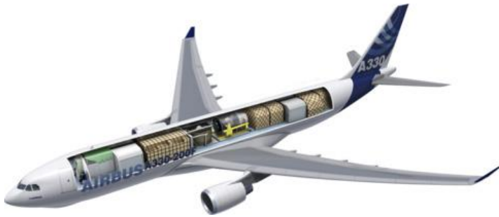
Bild 5.4 Frachtraum im Hauptdeck eines Airbus A330-200F (Airbus 2012c)
