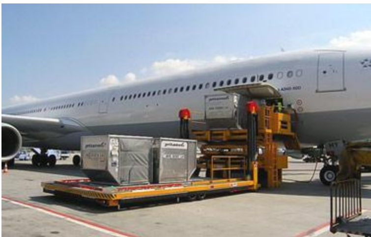
Bild 6.4 Hubbühne an vorderer Ladeluke eines Airbus A340 (Laweco 2012)
