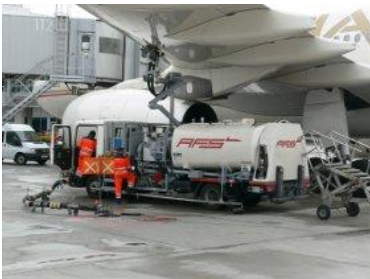
Bild 3.15 Pumpenfahrzeug bei der Betankung (Rohr 2012)
