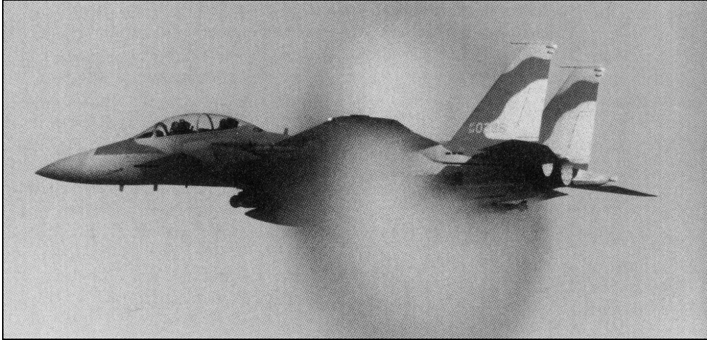
Bild 3.2 Kampfjet F-15I beim Flug in feuchter Luft (nach Bertin 2002)
