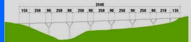
Viaduc d'épaisseur variable
