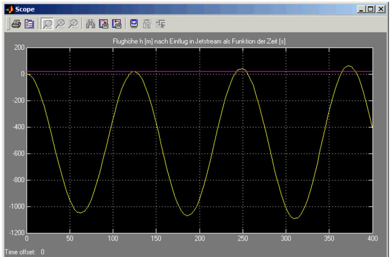
Durch den Einflug in den Jetstream wird die Phygoide angeregt. Aus der Periode von etwa 125 Sekunden kann man die Kreisfrequenz errechnen und erhält etwa den gleichen Wert wie aus dem Eigenwert nach Aufgabe 2.1) c). Man sieht das die Phygoide – wie erwartet – leicht instabil ist. Durch die Böe als Rückenwind verliert das Flugzeug im ersten Schritt an Geschwindigkeit und damit auch an Höhe.
