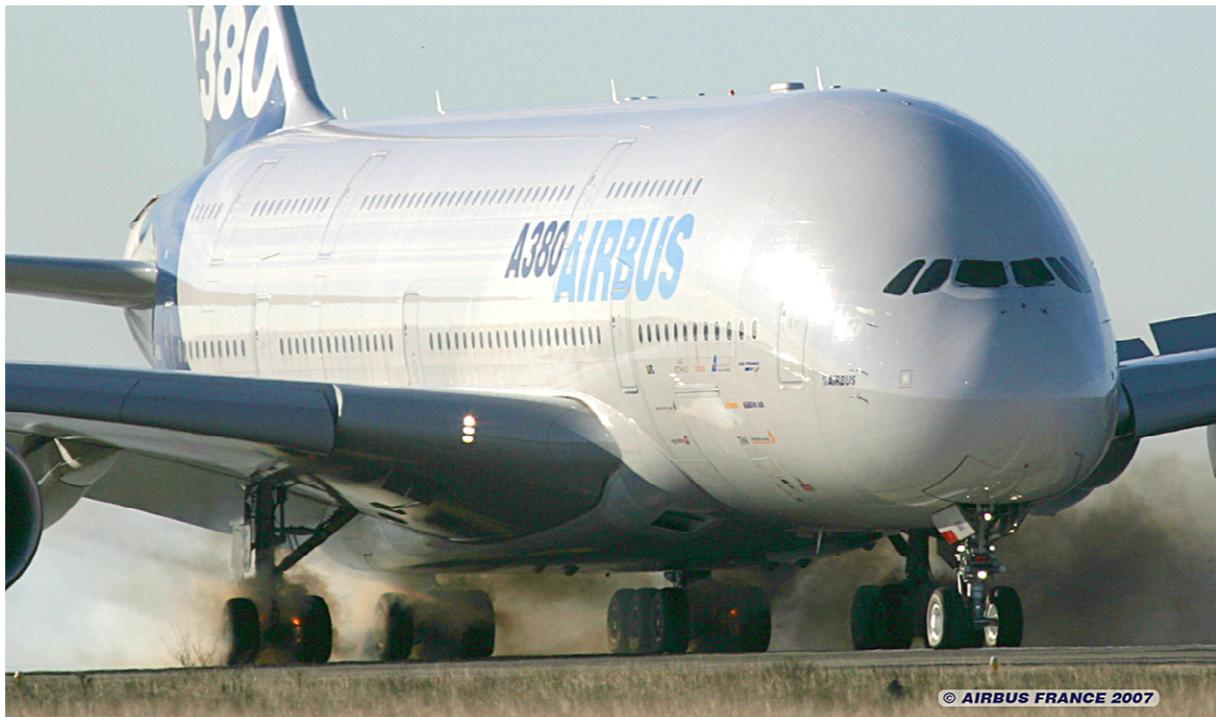
**Bild 10.4:** Startabbruch im Rahmen der Flugerprobung Airbus A380. Zu beachten sind die glühenden Bremsen. (Quelle: Airbus)
