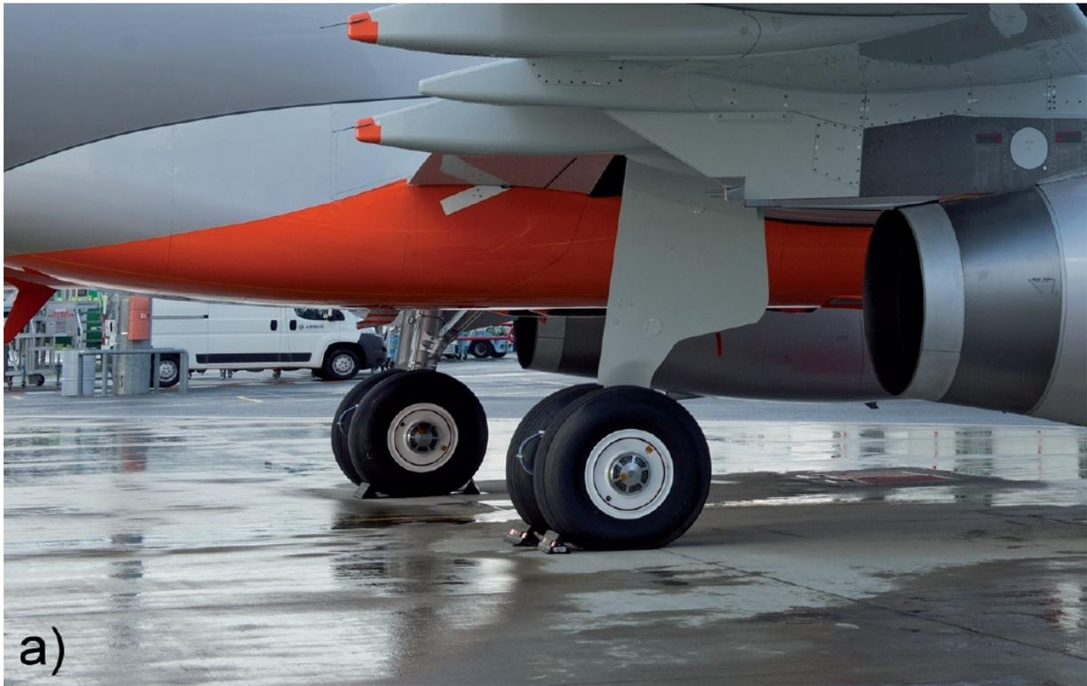
Bild 10.7a: Hauptfahrwerk Airbus A320
