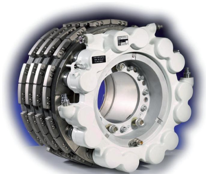
**Bild 10.17:** Carbonbremse der Airbus A320-Familie
